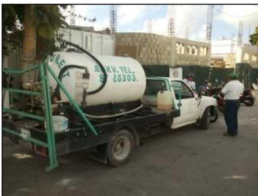
La imagen corresponde al tipo de pipa (No de capacidad, la empresa tiene de mayor capacidad) que es utilizada por la empresa para el traslado de las aguas residuales y lodos hacia la planta de tratamiento.
