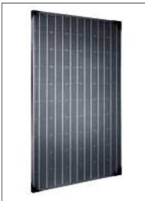
Los generadores fotovoltaicos (conjunto de placas fotovoltaicas) captan la radiación solar y la transforman en energía eléctrica. El conjunto será agrupado en tensiones de corriente continua a 12V, 24V o 48V en función del tamaño de la instalación. Se pueden instalar en cualquier superficie libre de sombra (tejados, terrenos...) y tienen una vida estimada de 40 años.
