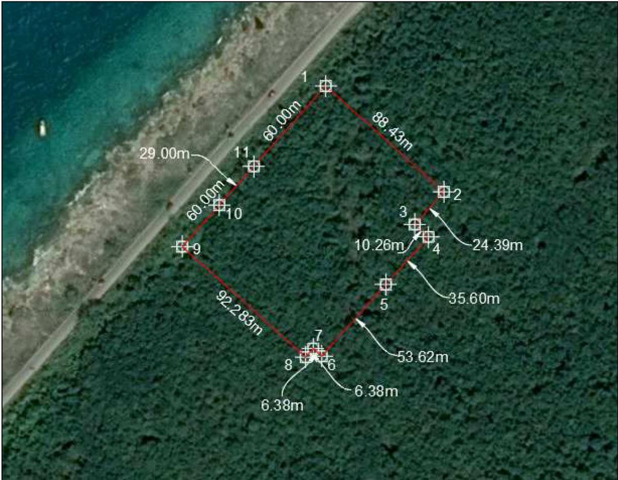
Imagen que muestra los vertices del poligono del predio. Cada vertice esta enumerado para su identificacion en el cuadro de construccion.
