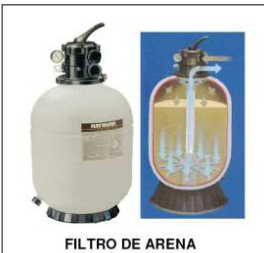
En el filtro de arena el agua pasa desde la parte superior a la parte inferior por medio de un distribuidor y se colecta en el fondo con un canasto de rejilla. Los sólidos son retenidos en el medio granular del filtro y el agua sale una vez filtrada y se regresa a la piscina para ser distribuida a lo largo de esta por los jets de la piscina.
