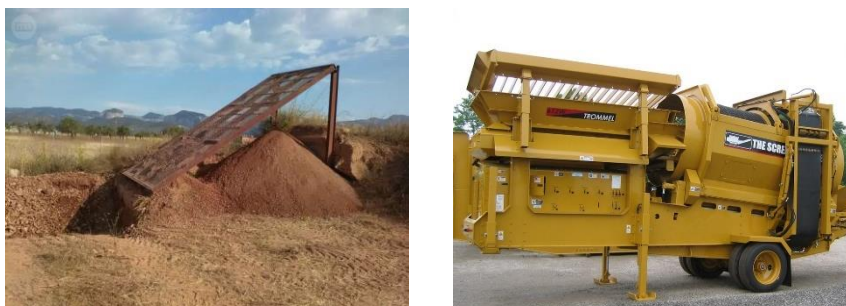
Figura VI:4. Ejemplo de equipo que se empleará para el cribado de tierra vegetal
