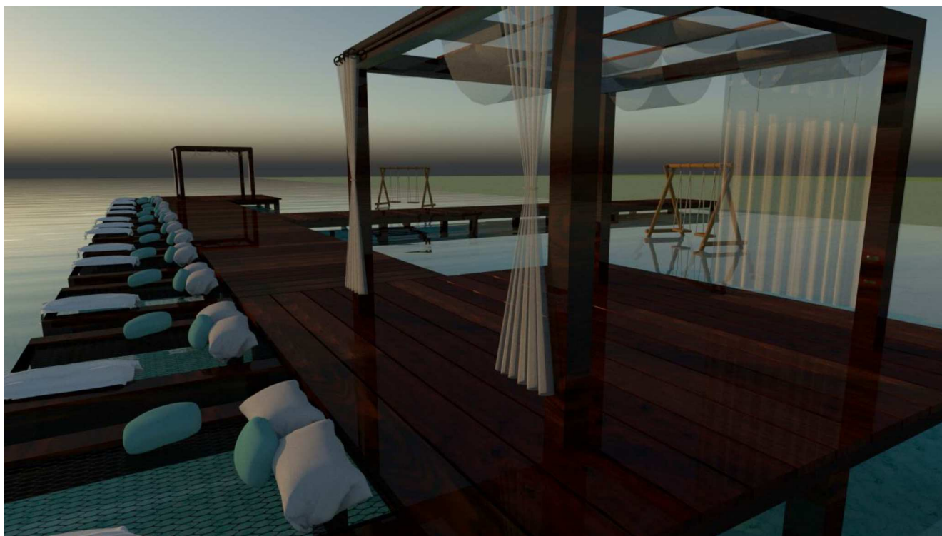
Figura 11.- Modelo computarizado del muelle de madera. Se observa la “T”, como detalles podemos apreciar como quedarán las camas red, mismas que sobresalen de la estructura del muelle, es decir o requieren de pilotes para su colocación, solamente se prolongan los largueros para colocar la malla.
