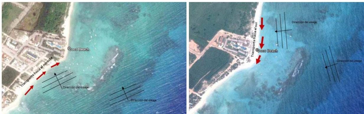
**Figuras 4.15.** Transporte del sedimento frente al proyecto. A) Con componente del Norte, B) Con componente del sur. Fuente: Análisis de erosión en playas adyacentes al Hotel The Reef Coco Beach, PROCOMAR 2015.
