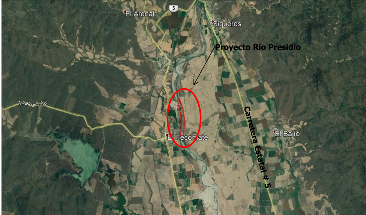
FIGURA 19.- APRECIACIÓN DEL PROYECTO DENTRO DEL RIO PRESIDIO. EL MEANDRO FORMADO POR ACARREO DE SEDIMENTOS HACIA LA MARGEN IZQUIERDA HA DESVIADO LA CORRIENTE SOLO A LA MARGEN DERECHA.
