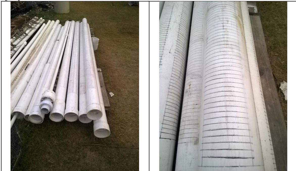
Imagen No. 16.- Tubería utilizada para la extracción del agua marina
