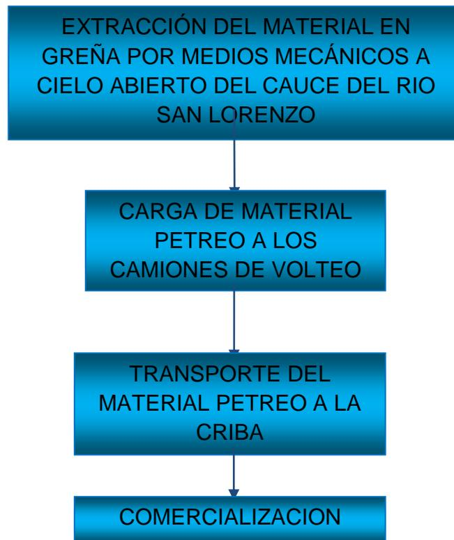
**Extracción:** La extracción del material pétreo en greña se llevara a cabo con una Excavadora 330 CL.
