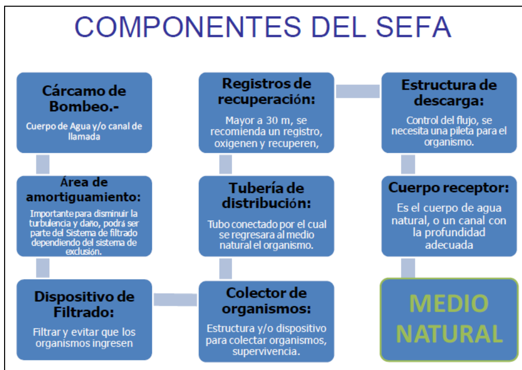
Imagen 9. Componentes de una SEPA
