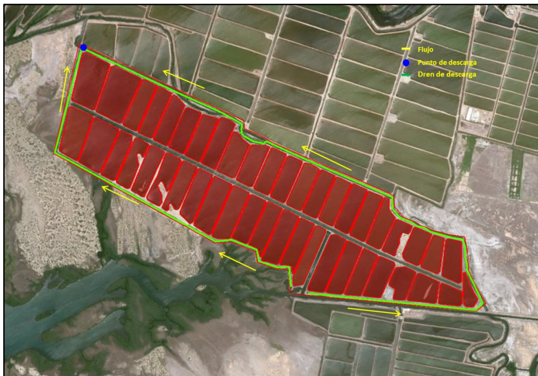
Figura II.5 Drenes con sus flujos y punto de descarga en la granja ACUASHIRMP SPR. DE R.I.
