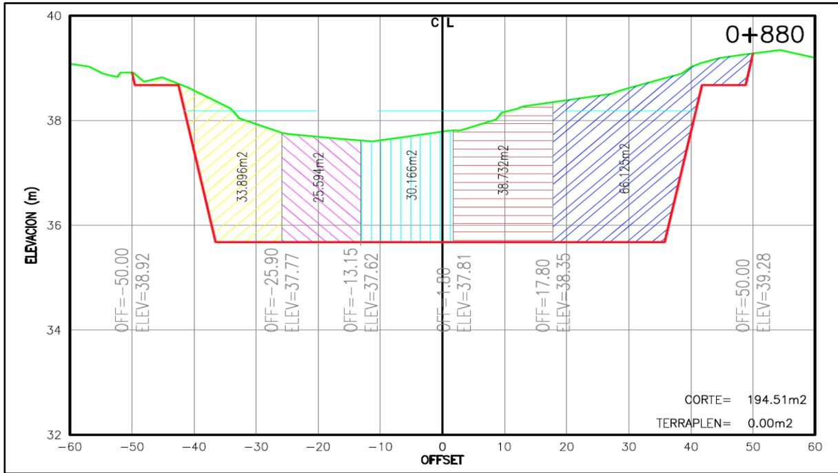
Figura II.2.- Secciones transversales
