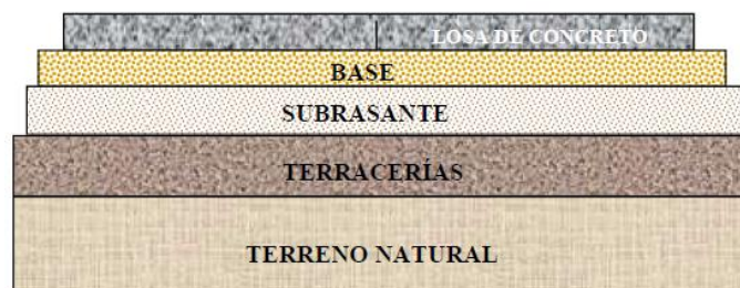
FIGURA II.15. Estructuración de un pavimento rígido.
