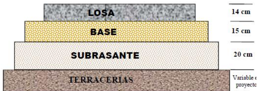
FIGURA II.16. Espesores de pavimento rígido
