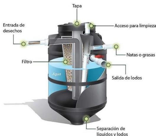
**Figura 2.25** Biodigestor sugerido
