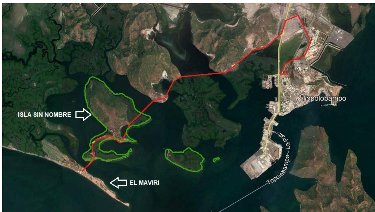
FIGURA 25 TRAZO DEL TENDIDO DE FIBRA ÓPTICA DESDE TOPOLOBAMPO A EL MAVIRI Y SU PASO POR UNA DE LAS ISLAS QUE FORMAN PARTE DEL APFF ISLAS DEL GOLFO DE CALIFORNIA.
