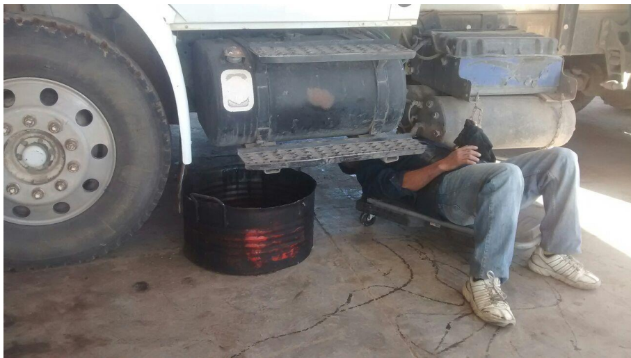
Imagen 14. Charola metálica para evitar derrames.
