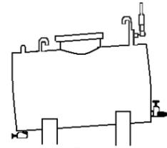
El tapón de salida final debería estar situado para permitir una profundidad de asentamiento de 3 pulgadas (75 mm) para agua y barro; debería alimentarse a través de un filtro desmontable con una rejilla de malla. Debería haber una caída de aproximadamente 0.5 pulgadas por pie (40 mm por metro) hacia el tapón de drenaje de barro.
