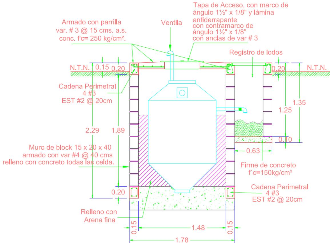
Ilustración 28.- Detalle Biodigestor
