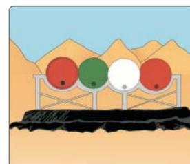
revestimiento de plástico. En cualquier caso, la zona de contención debe mantenerse limpia para permitir la recuperación del producto derramado. El volumen de contención debe ser algo mayor que el volumen almacenado en los contenedores. Las válvulas, bombas y sellos de todas las instalaciones deben estar en buenas condiciones para permitir cierres herméticos.
