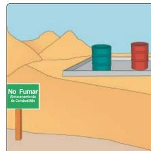
Para el almacenamiento de materias inflamables se debe utilizar contenedores apropiados y se debe evitar derrames en las operaciones de trasvasije. Debe evitarse el almacenamiento en lugares donde operen equipos eléctricos. El riesgo de incendio y las medidas de prevención deben indicarse con señalización adecuada en los lugares donde sea necesario. Se debe mantener equipos extintores adecuados en los lugares críticos
