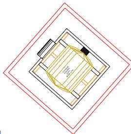
Ilustración 15.- Diseño del depósito de diésel.
