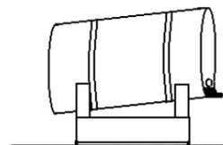
6. Los tanques en uso al aire libre deben tener el tapón firmemente atornillado para evitar el ingreso de agua.
