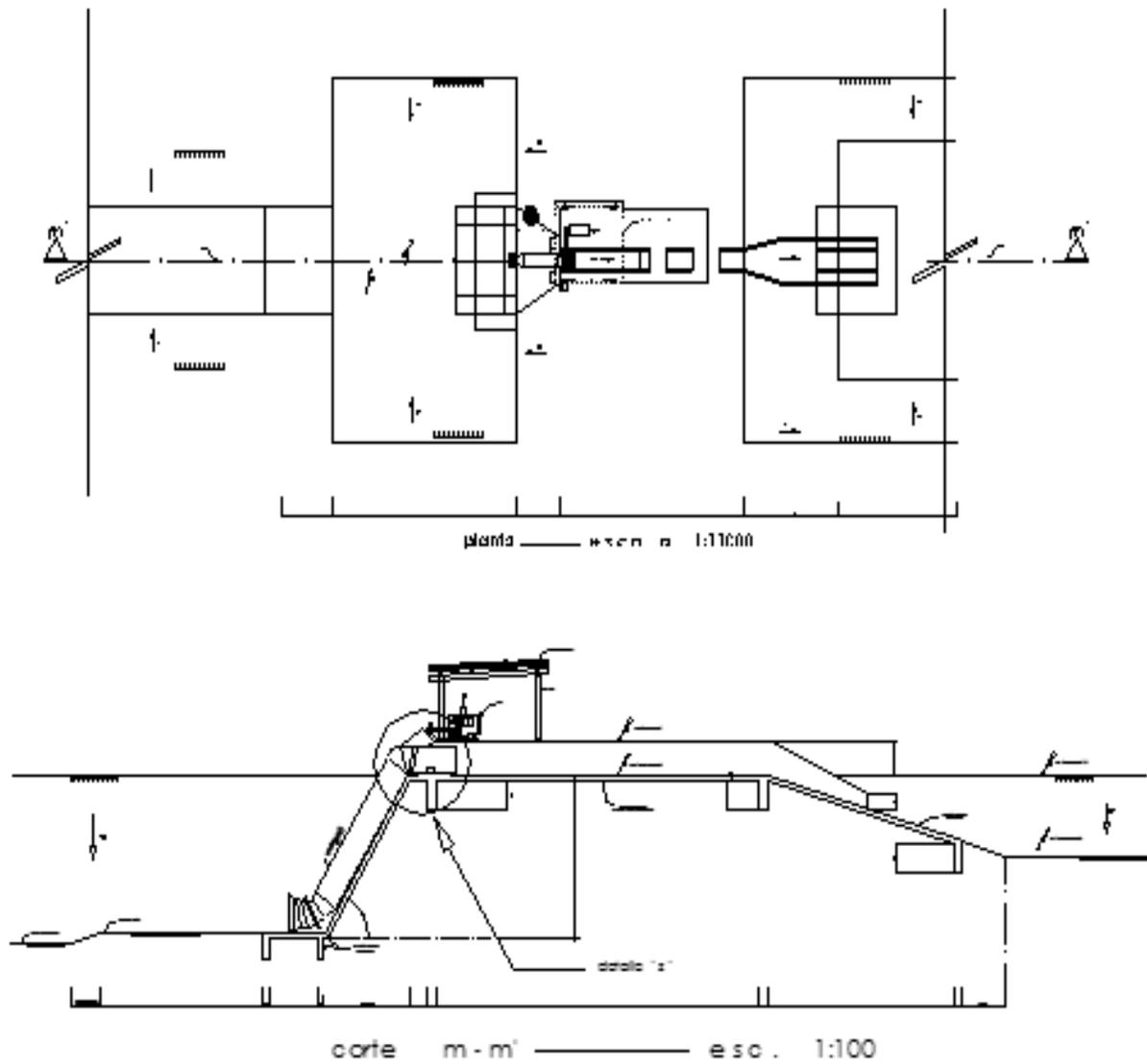
Ilustración 8.- Ingeniería cárcamo de bombeo
