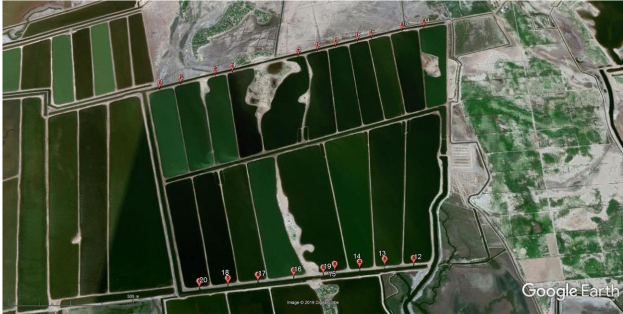
Figura 12. Distribución de las compuertas de salida a lo largo de la estanqueras de acuícola XXXXXXXX, generalmente una por cada estanque (interior, en estanque; exterior, canal de salida) se incluyen compuertas en reservorios.
