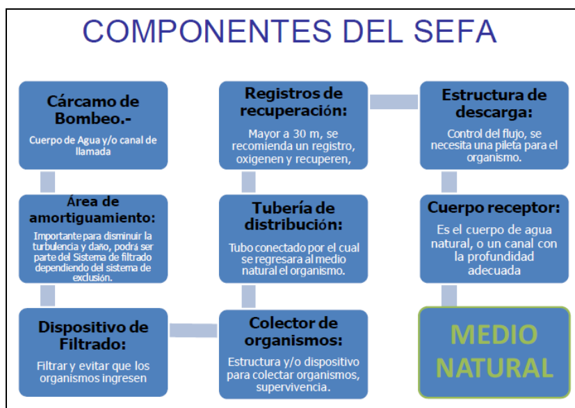
FIGURA 20. DIAGRAMA DE LOS COMPONENTES DE SISTEMA DE EXCLUSIÓN DE FAUNA ACUÁTICA (SEFA).
