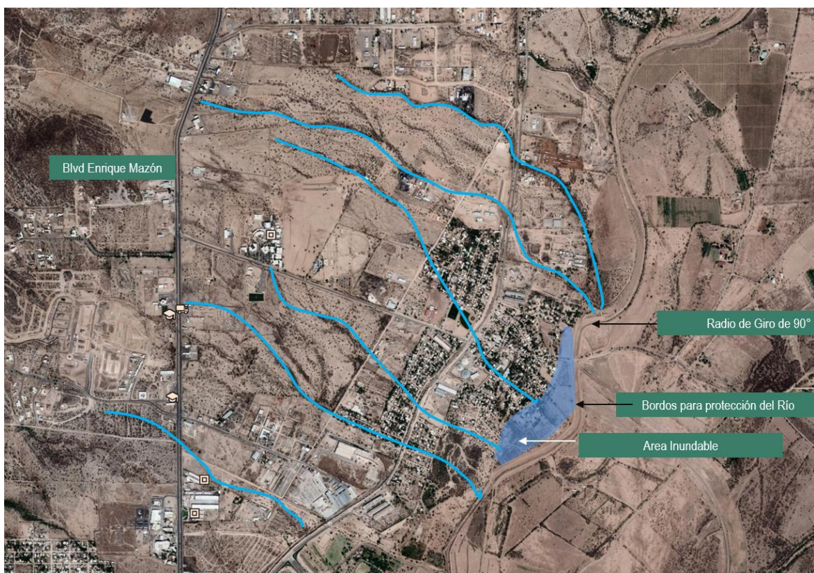
Figura II.14.- Afluentes pluviales que afectan a La Victoria provenientes del poniente del Blvd. Mazón
