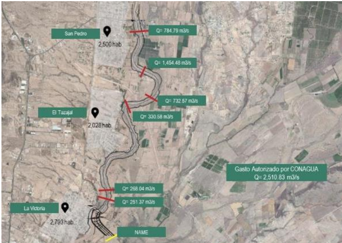
Figura II.4.- Levantamiento Actual Río San Miguel. Tramo Puente de San Pedro al NAME de Presa Abelardo L Rodríguez
