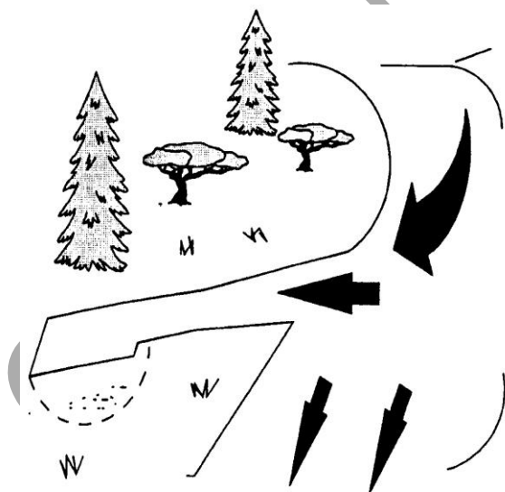
Figura 2. Trampa de sedimento.
