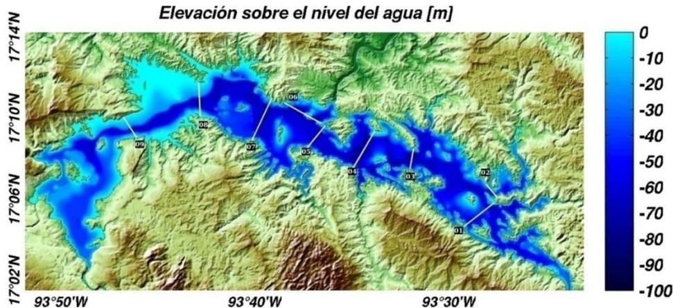
**Mapa señalando secciones verticales para analizar velocidad de flujo**
