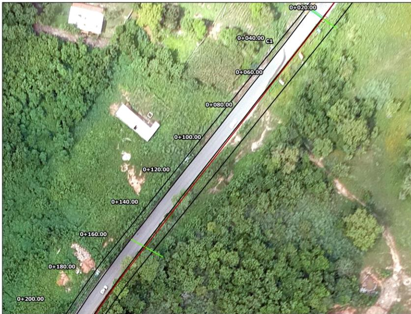
Fotografía 11. Vista satelital tipo plano del Km 0+000 al 0+200, en el cual se puede apreciar el ancho existente de la carretera que se pretende ampliar; nótese como en un tramo de casi 200 metros lineales solo se encuentra arboles aislados colindante con el margen del ancho por ampliar, por lo que en algunos casos será necesario podarlos y en casos extraordinarios talarlos.
