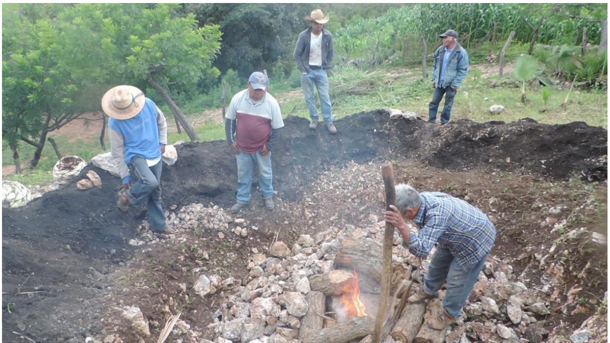
Figura 27. Encendido del horno y colocación de piedras.
