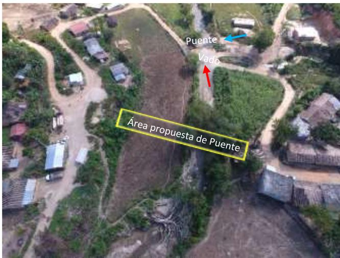
Imagen 7. Fotografía aérea Aguas Abajo del área propuesta del Puente Plan Buenavista, se puede observar con la flecha roja el cruce del río mediante el vado, mientras que la azul señala el puente peatonal colgante de madera inoperante.
