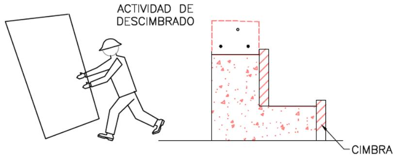
Figura 1.16 Descimbrado de la corona y muro de respaldo
