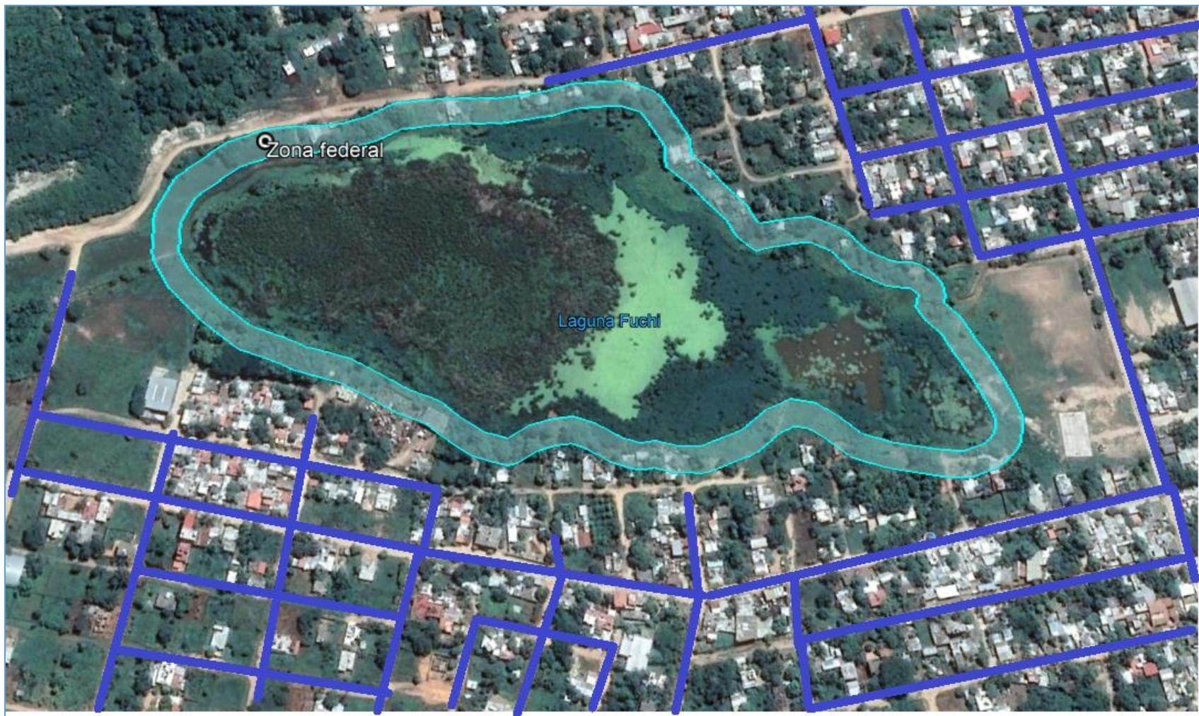
Ilustración II-19 zona Feral de la Laguna Fuchi, y localización de la red del colector, Nótese que no se ocupara la zona federal, sin embargo en las orillas de la laguna existen edificaciones que corresponden a viviendas unifamiliares mismas que vierten sus aguas residuales a este cuerpo de agua.
