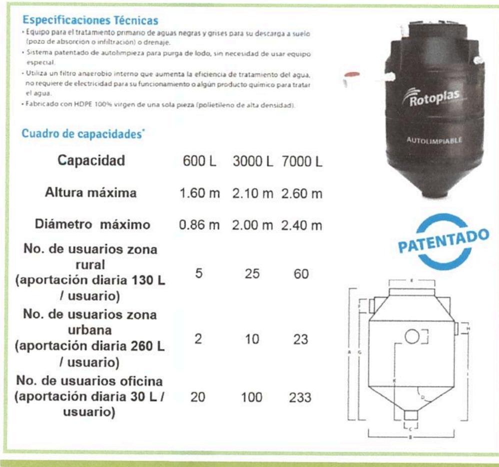
Figura III.2.4.2. Vista panorámica del Biodigestor Autolimpiable, con diferentes capacidades para tratar las aguas residuales.
