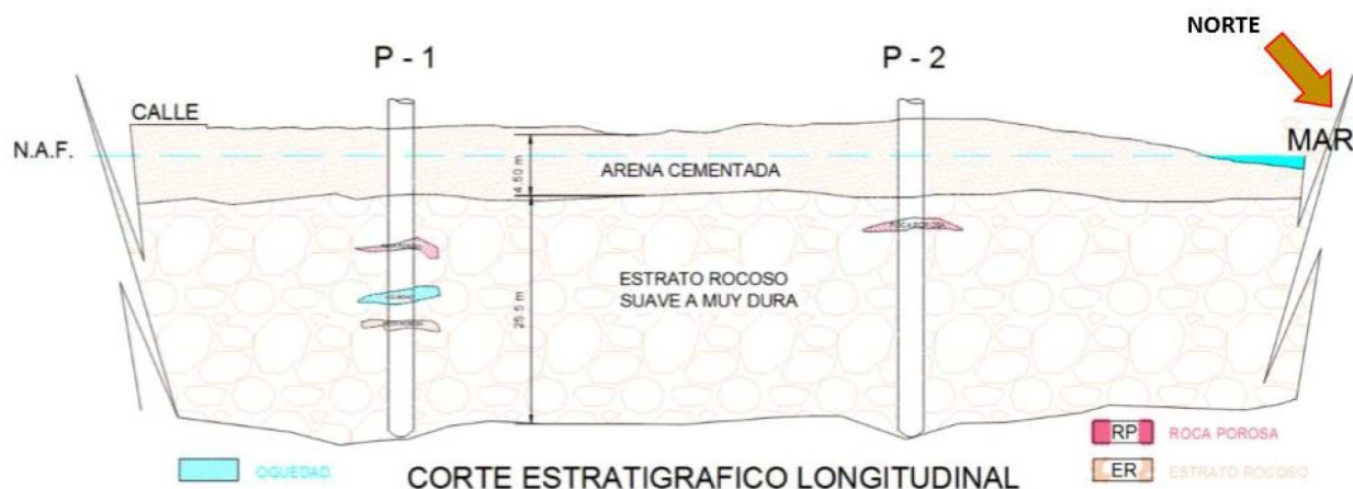
Figura 42 Estratos y nivel freático registrado en el área del proyecto
