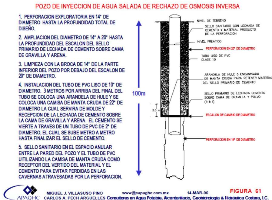
Imagen 6.- Diseño del pozo de rechazo (Fuente: estudio geohidrológico)
