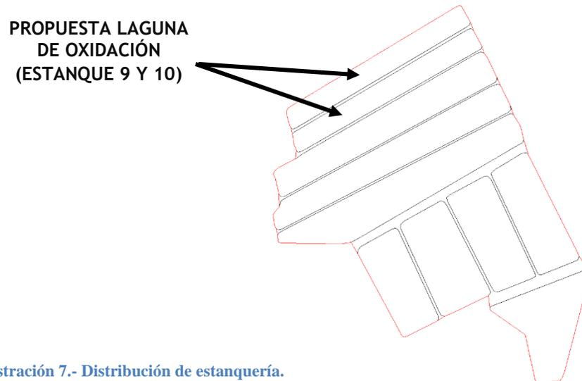
Ilustración 7.- Distribución de estanquería.
