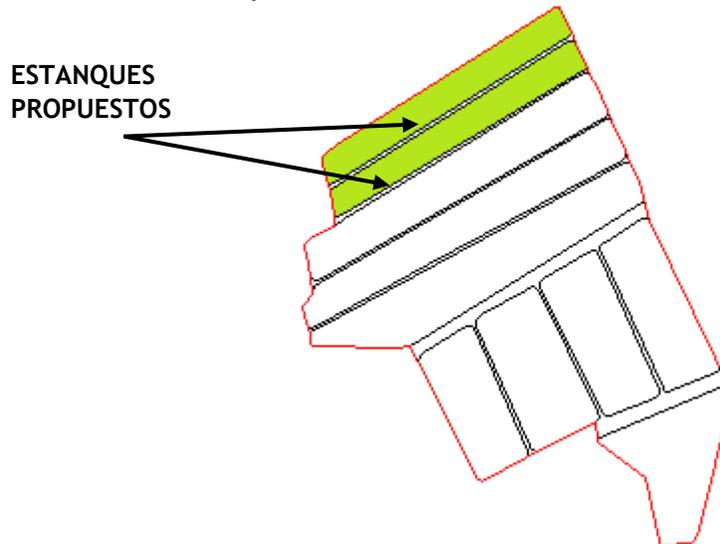
Ilustración 28.- Estanques 9 y 10 propuestos para estanques de oxidación individuales.
