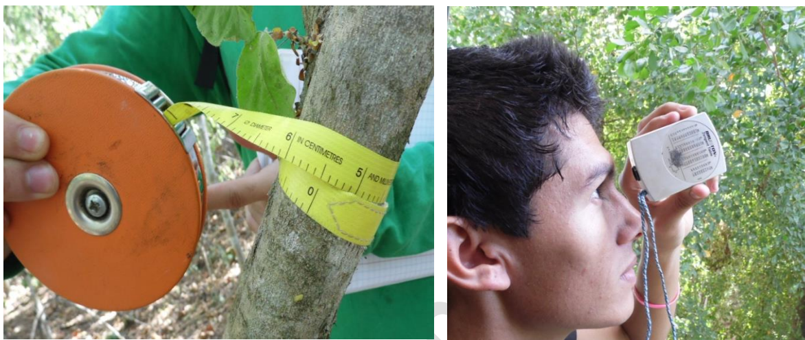
Imagen No. 63.- Uso de cinta diamétrica y clinómetro en la toma de datos para cubicación
