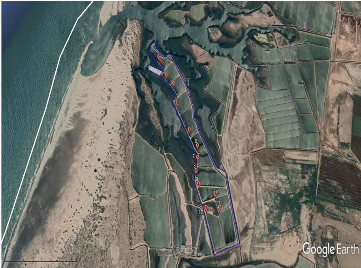
Figura 14. Distribución de las compuertas de salida a lo largo de la estanqueras de Acuicola Alpina, generalmente una por cada estanque (interior, en estanque; exterior, canal de salida) se incluyen compuertas en reservorios.
