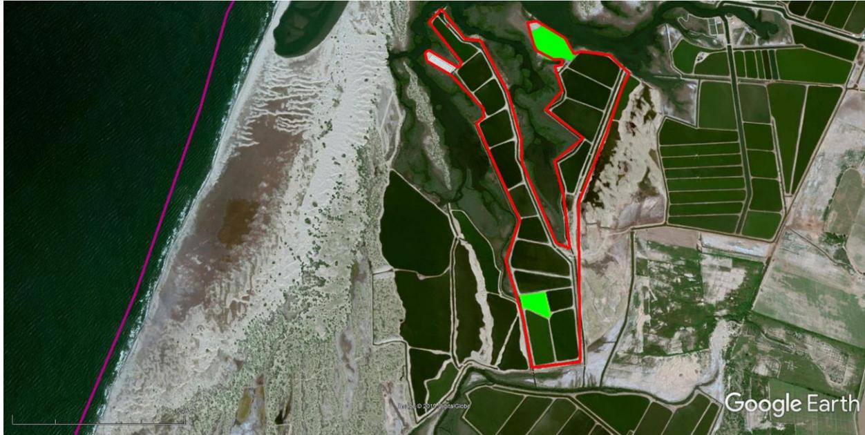
Figura 19. Lagunas de sedimentación para disminuir la carga orgánica y otro detritus del camarón dentro de las instalaciones de la granja acuícola Alpina.
