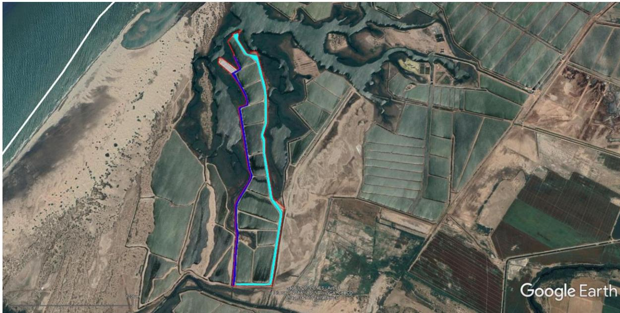
Figura 09. Sistema de canales de llamada que no existen por estar colindante a los canales naturales del Estero San Juan, reservorio (azul bajo) y canales de salida color azul en acuícola Alpina.
