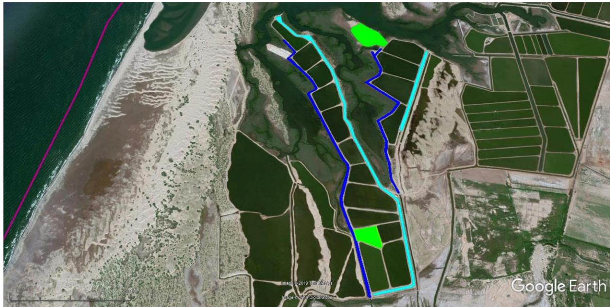
Figura 10. Lagunas de oxidación proyectadas dentro del complejo de estanques de producción y áreas de raceways de Acuicola Alpina.
