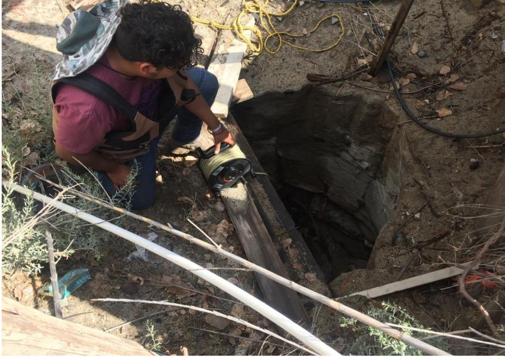
Fotografía 14. Que muestra la medición del Nivel Freático
