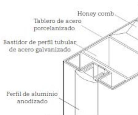
La mampara imperial troquelada es un sistema modular de equipamiento para baños, conformado de divisores, fijos y puertas fabricados en lámina de acero porcelanizado. Son adecuadas para todas aquellas instalaciones que requieren un acabado limpio, elegante y de alta resistencia.
