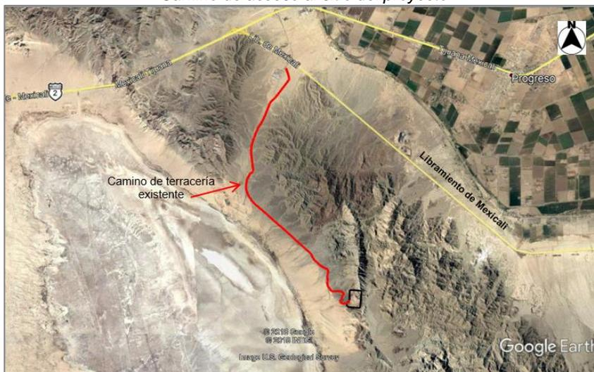
No se incluye un diseño de camino excepto el raspado, compactado y agregar una capa de revestimiento, que será una mezcla de grava, gravilla y arena con limo, en partes proporcionales. Se utilizará agua para el riego de los caminos y su compactación.
