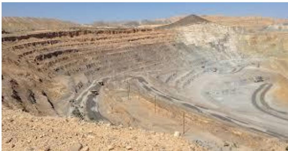
La altura de los tajos será de entre 11 a 15 m. Para ello se utilizarán explosivos y maquinaria pesada.
