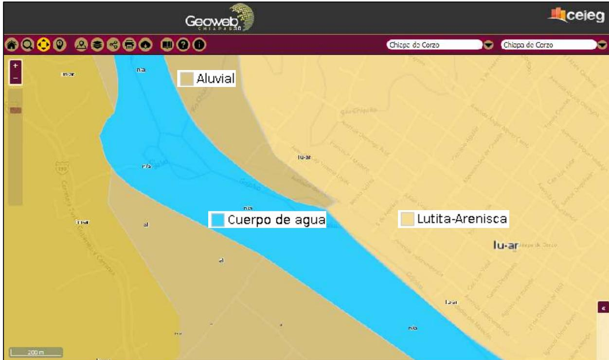
Fig. 12 Ubicación del sitio del proyecto asentado sobre rocas de tipo Lutita – arenisca y Aluvial.
