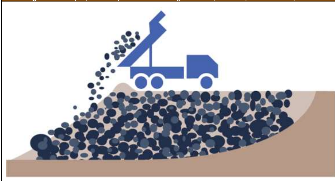
Figura II-24. Ejemplo de la operación de descarga en los depósitos superficiales de tepetate.
