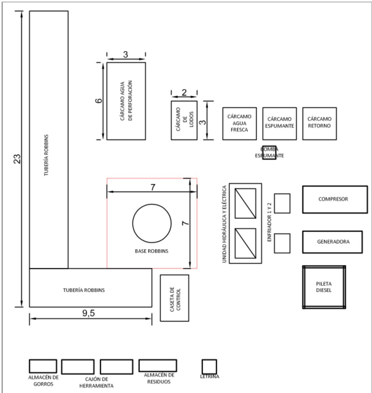
Figura II-3. Arreglo general de un Robbins
