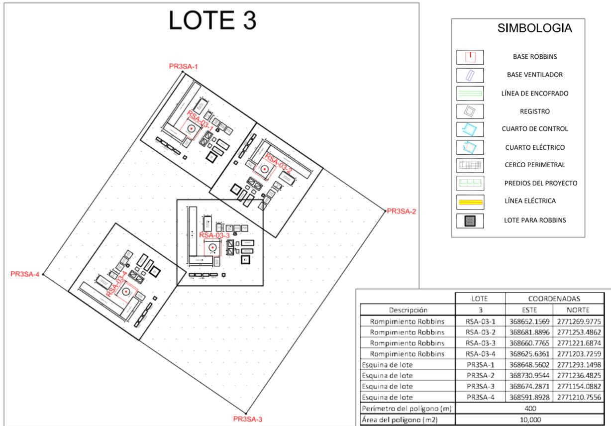
Figura II-2. Diagrama de la instalación de un robbins
