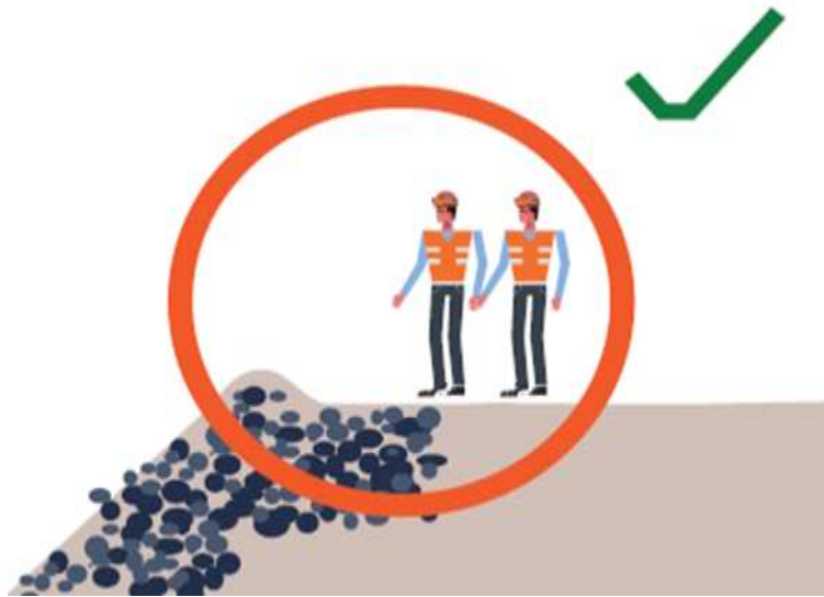
Figura II-19. Inspección del piso cercano al borde de los depósitos superficiales de tepetates.
