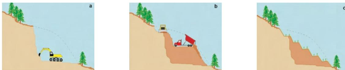
Figura II.3. Proceso de suavización de un talud: a) condición original, b) acomodo de material de relleno y suelo vegetal, y c) realización de terrazas y establecimiento de cubierta vegetal (Fuente: Ruiz-Prieto, 2008).
