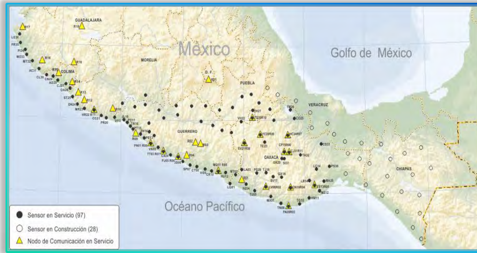
Figura 18.- Sistema de Alerta Sísmica Mexicano (SASMEX®).
