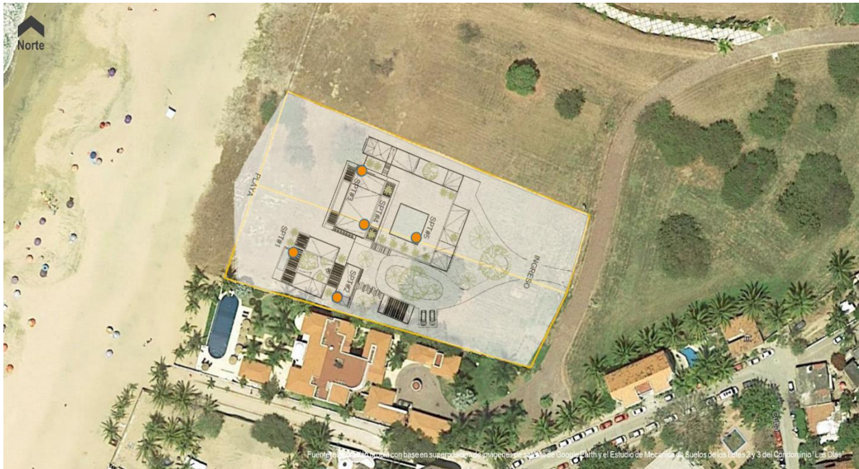
Figura 52. Ubicación del sondeo de penetración estándar (SPT)
