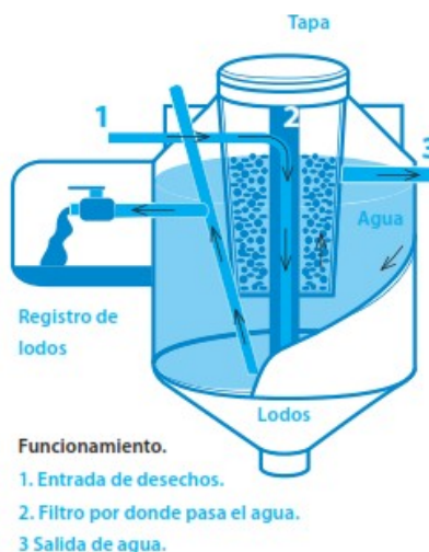
Imagen 1. Funcionamiento del Biodigestor Autolimpiable
