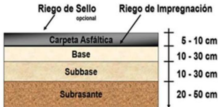
La base que se utilizará para este proyecto, será una base hidráulica de 25 cm, la cual será compactada al 100% de su Peso Volumétrico Seco Máximo.
