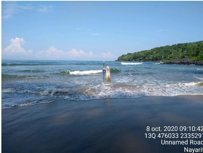
*Ilustración 11.- Seccionamientos playeros lado mar.*
