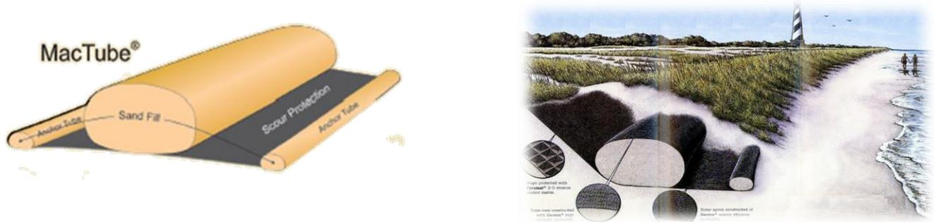
**Figura 1-2 Sección tipo Mactube**
