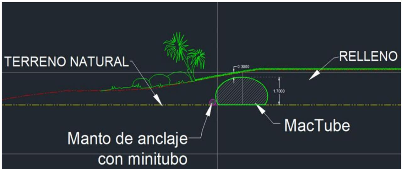
**Figura 1-3 Diseño conceptual del elemento denominado Mactube**
