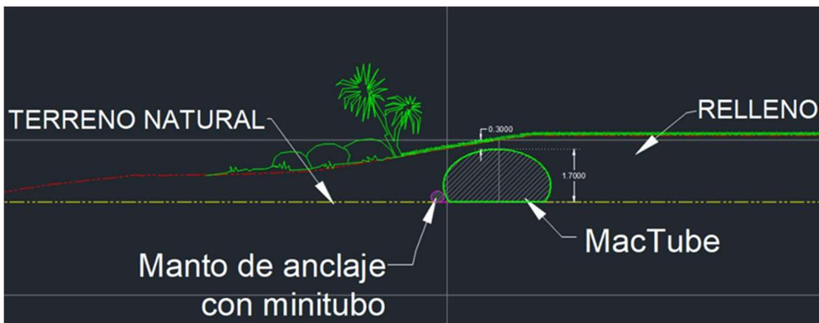
Figura 2. Sección tipo de Duna estabilizada con Mactube.
