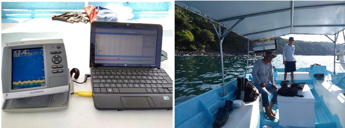
**Ilustración 16.- Equipo batimétrico montado en una lancha con motor fuera de borda.**
