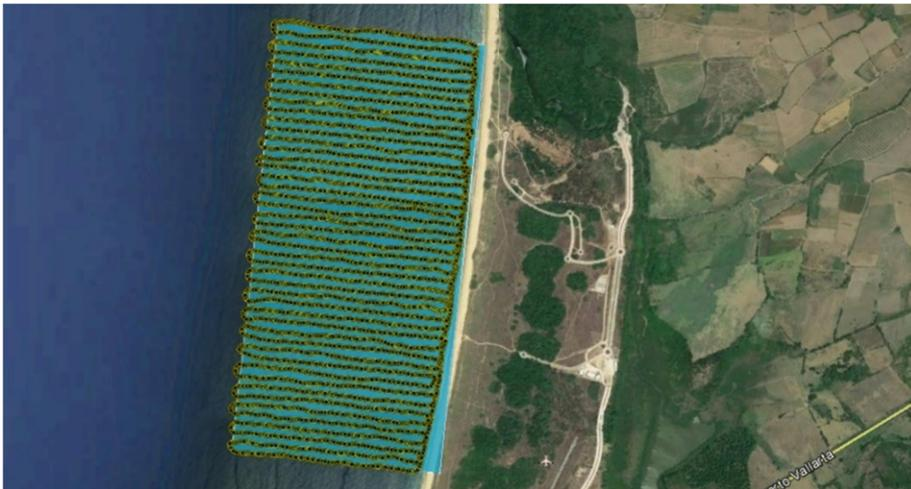
**Ilustración 17.- Puntos de la batimetría (Fijas), con recorridos en Lancha, siguiendo líneas planeadas**
