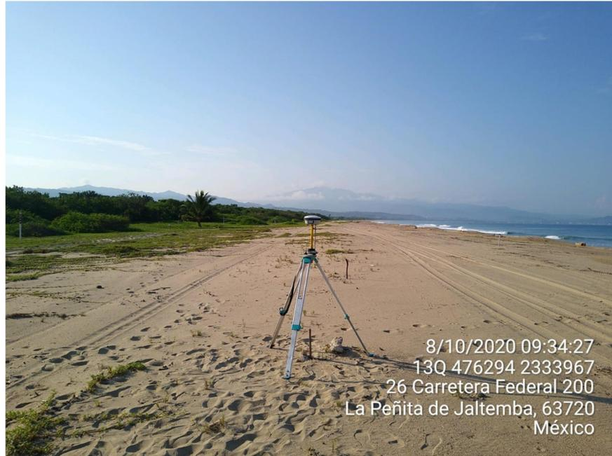
***Ilustración 10- GPS base haciendo estación en vértice con coordenadas conocidas.***
