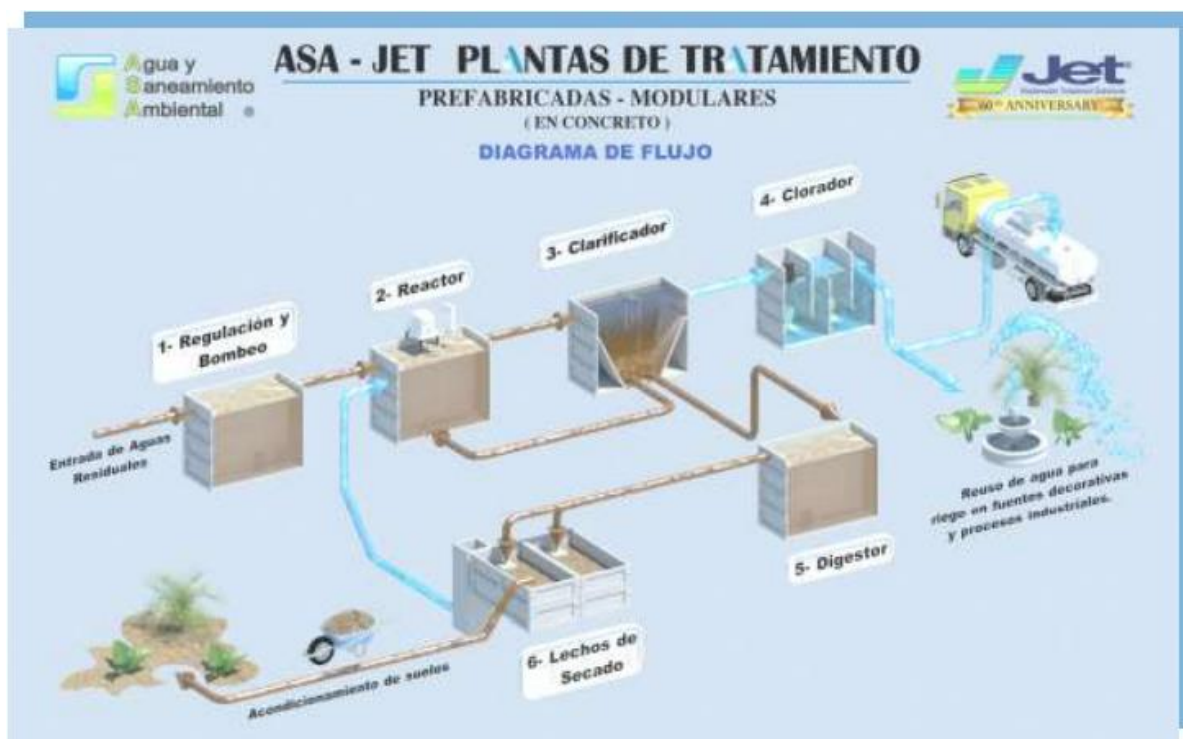
Figura II.7 Etapas de funcionamiento PTAR.
