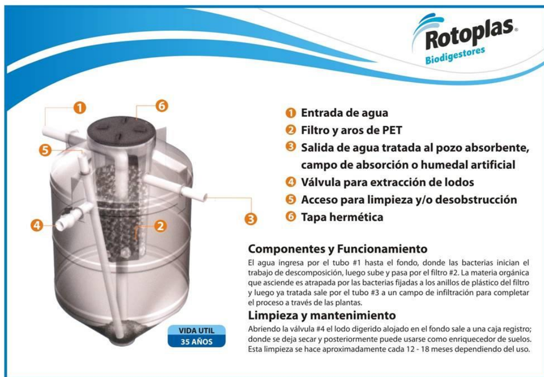
Ilustración II-7 Tipo De Biodigestor A Instalar En Cada Una De Las Casas.
