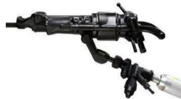
Perforador o máquina de pierna (Neumática)
