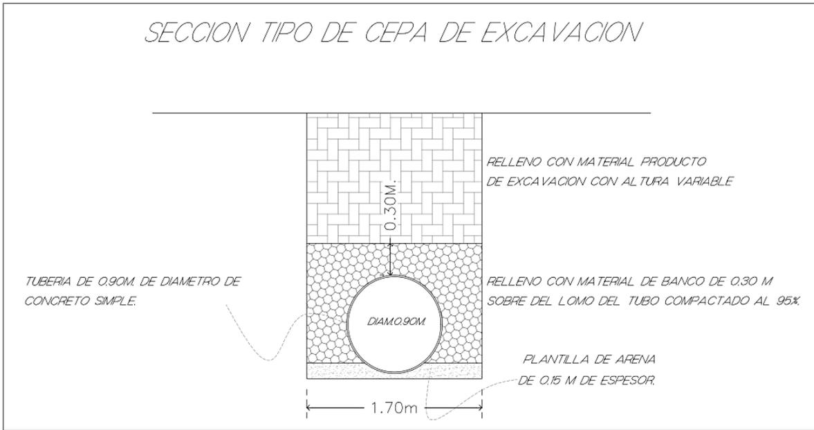
**Figura II.2.4.3.** Diseño hidráulico del proyecto
