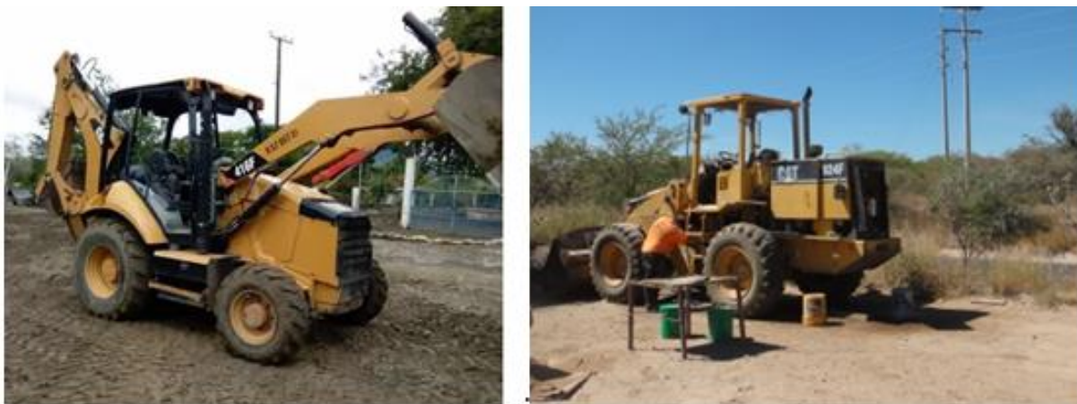
Ilustración 2. Equipo de excavación y carga (Retroexcavadora y carga frontal)
