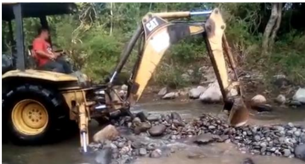
Ilustración 10. Extracción y manejo del material pétreo con retroexcavadora.
