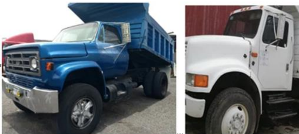
Ilustración 3. Camiones de volteo para el flete de los materiales de 6 m 3 .
