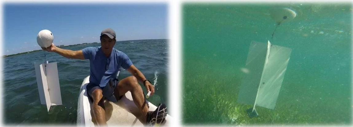
*Figura IV:20. Colocación de crucetas de deriva. Fuente: Sylvatica ®.*
